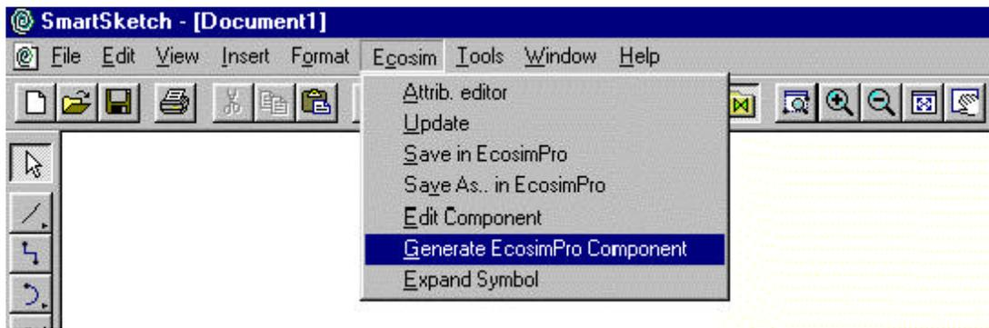
El usuario debe dar el nombre del componente y la librería de EcosimPro donde insertarlo. Posteriormente el sistema extraerá automáticamente la topología del esquema y generará el código EL para el nuevo componente.
