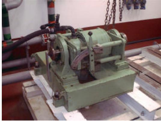
El freno consiste en el elemento disipador de la potencia dada por el motor, potencia disipada en forma de calor.
