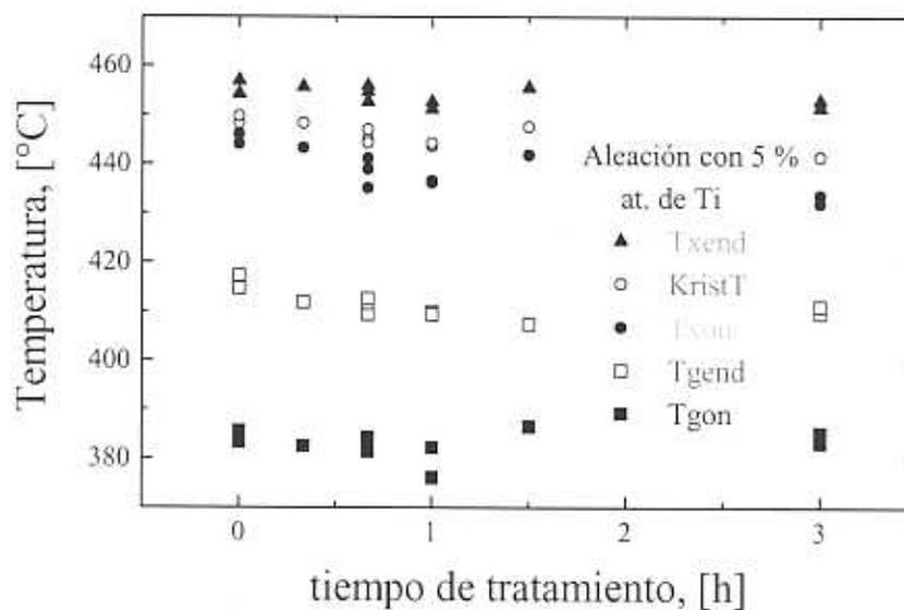
Fig.4.16: Descripción de la variación de las Temperaturas características de los vidrios metálicos en función del tiempo de recocido.
