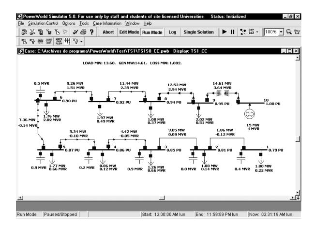
Figura 14.4. Simulación con POWER WORLD.
