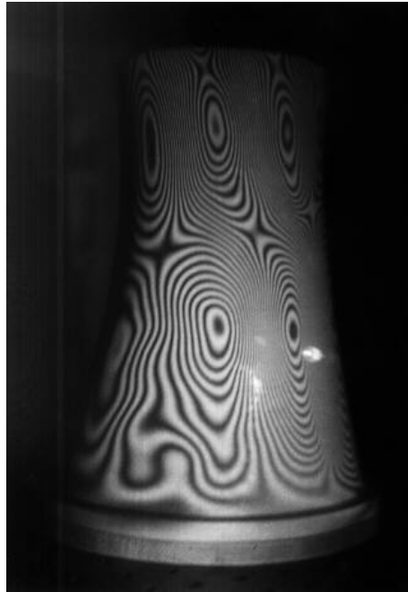
Figura 2. 20 Interferograma realizado sobre un modelo a escala de una torre de refrigeración [25]
