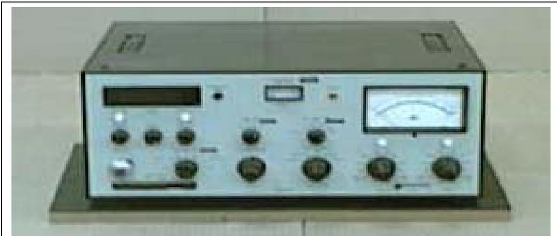
Figura 97. Controlador del excitador B&K Tipo 1047.
