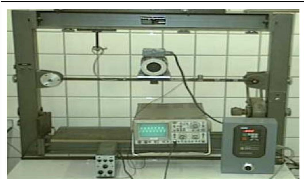
Figura 28. Montaje cuando la excitación es debida al desequilibrio del rotor
