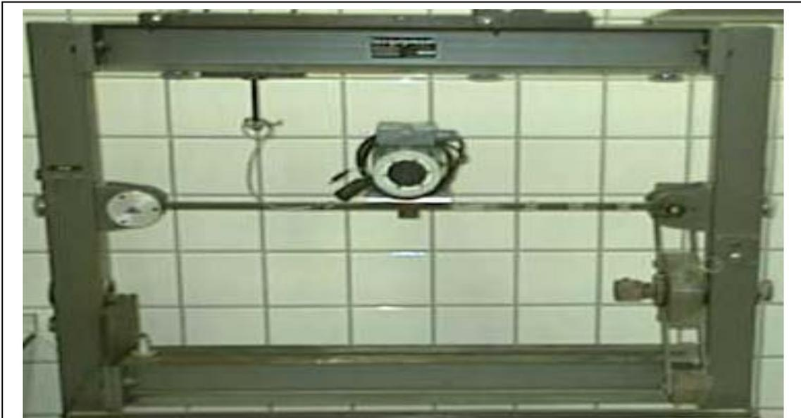
*Figura 3. Imagen de la viga biapoyada con una masa en el punto medio (motor).*
