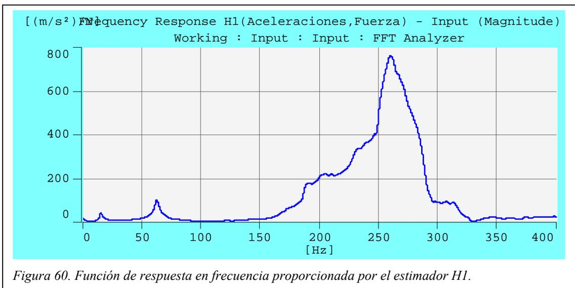
Figura 60. Función de respuesta en frecuencia proporcionada por el estimador H1.
