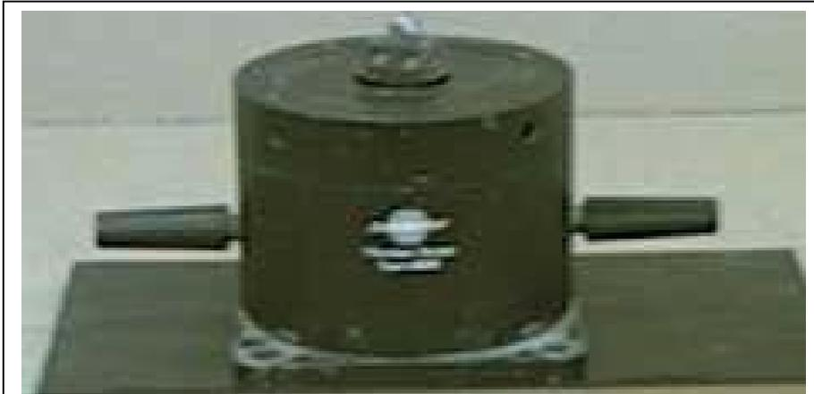
*Figura 99. Excitador Electrodinámico B&K 4808.*
