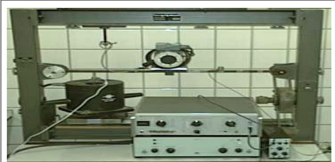
*Figura 69. Montaje del sistema cuando la excitación es debida al desequilibrio del rotor*
