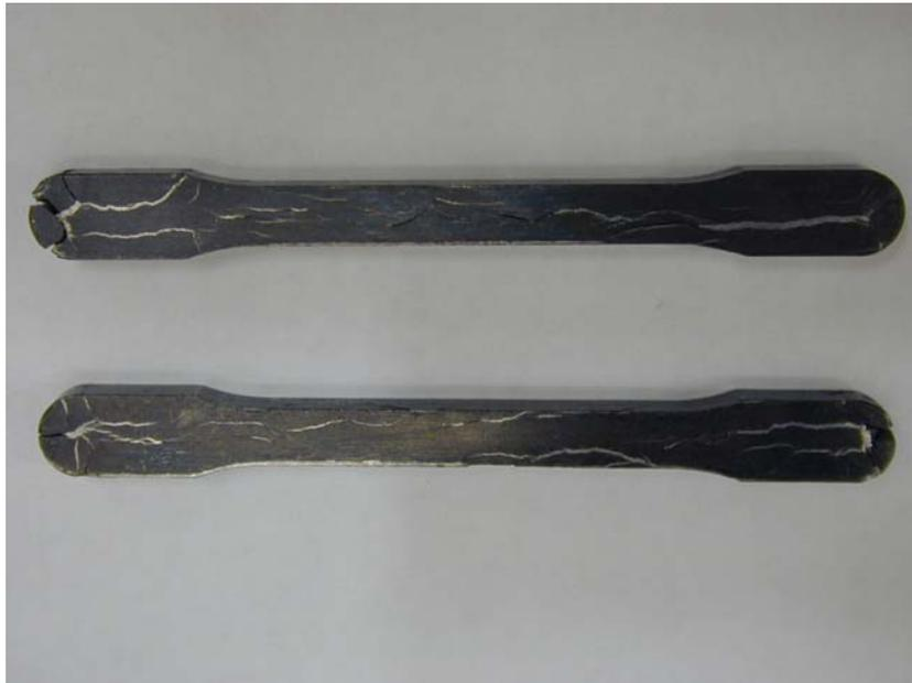
**Fig 55.** Foto de probetas de Al-10Ti(TiO<sub>2</sub>) sometidas a ciclo doble
