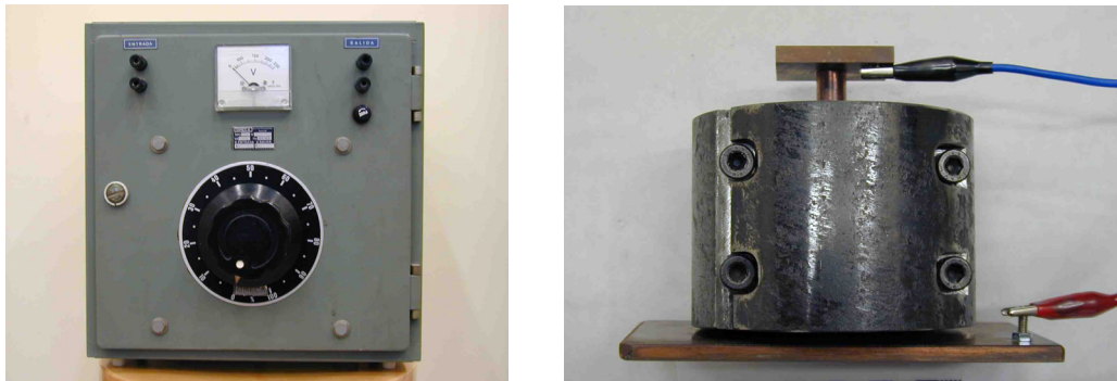
Figura 3.18 (a) Autotransformador y (b) pinzas de activación eléctrica.
