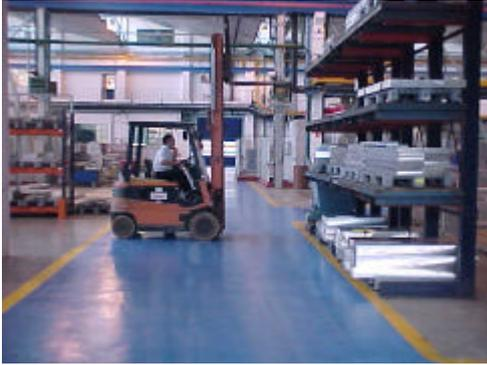
*En la imagen, un carro de uñas coloca un palet cargado sobre los brazos de una estructura CANTILEVER en la nave de Montaje de Tablada.*
