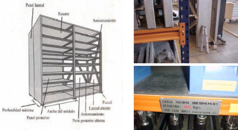
*Esquema de las estanterías usadas en el almacén Intermedio, con imágenes de detalle de las cruces de unión y de los letreros indicadores de la máxima carga permitida por bandeja.*
