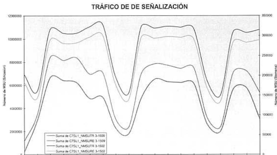
El día 9 se aprecia una disminución del tráfico en el Link Set 3-1509 y un aumento en el 3-1502. Aunque es día hubo una modificación de parámetros en las celdas de Siemens (cambios en RxLevAccMin, HO\_MARGIN, LRXQD), este efecto está relacionado con una indisponibilidad de los enlaces de señalización del Link Set 3-1509. Como consecuencia de esto el tráfico cursado por las celdas de Siemens disminuyó, absorbiendo el tráfico las de Ericsson.
