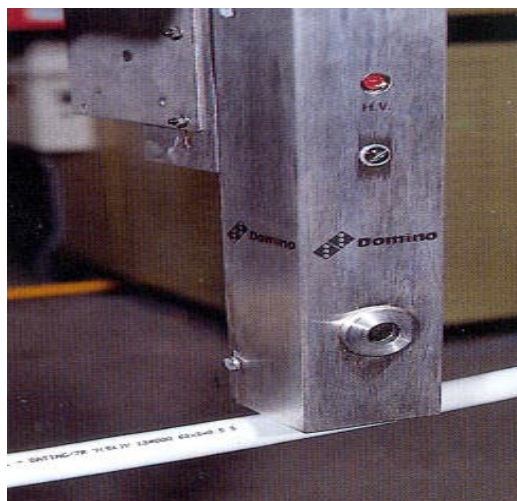
Figura III.9: Marcado de cubiertas en la línea de traseado final
