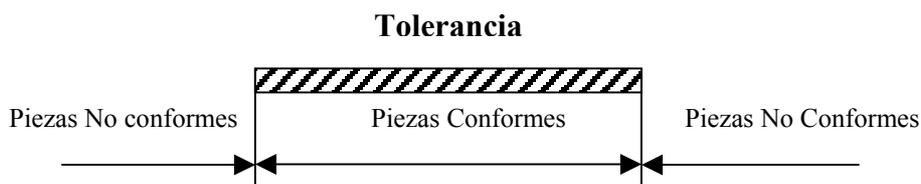
Figura 5: Esquema Tolerancia
