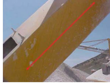
Fotografía nº 42 - MOLINO/MM-20. Señalizar riesgo de golpeo en la cabeza.
