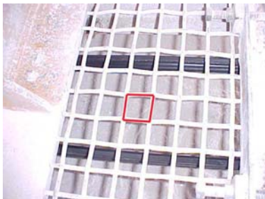
Fotografía nº 61 – MOLINO/MV-2352. Resguardo insuficiente por tamaño de la luz de malla.
