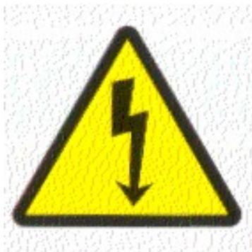
En todas las partes en tensión debe existir protección contra contactos directos, mediante alejamiento, interposición de obstáculos y aislamiento. Una solución muy extendida contra contactos eléctricos directos en los equipos de trabajo es la protección mediante envolventes (armarios o cuadros eléctricos). Como complemento a esta medida, se debe colocar una señalización en dicha envolvente, que indique el peligro eléctrico y que sólo se permite el acceso a personal autorizado.
