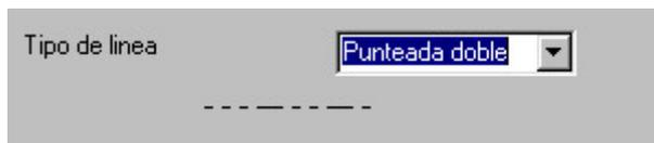
La Figura muestra el tipo de línea *Punteada doble* como seleccionado y en la parte de abajo una muestra de cómo sería el trazo utilizando el tipo de línea seleccionado.
