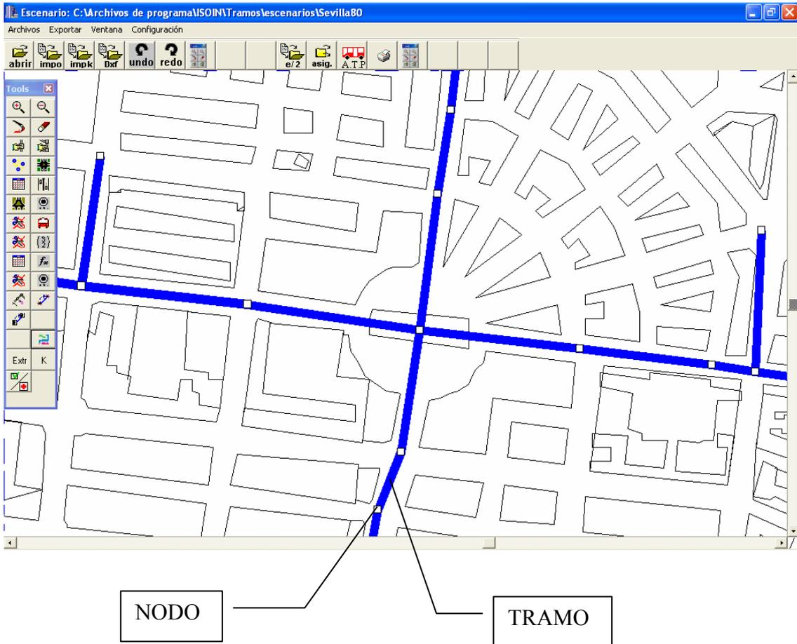
Aquí se puede observar con claridad la representación que tiene un nodo y un tramo. Los nodos son puntos de intersección de tramos, y estos últimos vienen dibujados en color azul.
