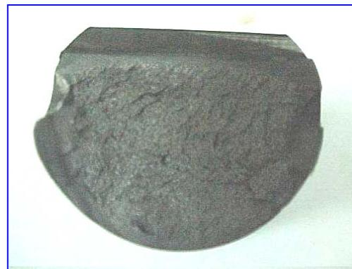
Sección de una pieza rota en dos partes por la enderezadora
