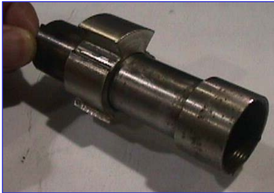
Útil para el ajuste de inductores en la inductora del temple de la parte posterior del dentado
