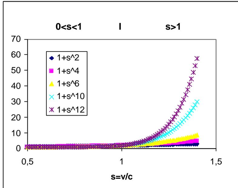
Fig. 3.1b. Funciones BPR para v/c mayores a 1 .
