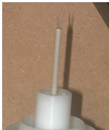
Figura 1.7: Sonda simple SN, modelo TP 55P11 de Dantec
