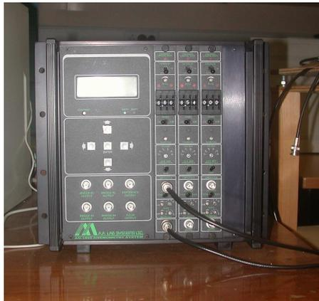
Figura 1.6: Equipo de anemometría de hilo caliente
