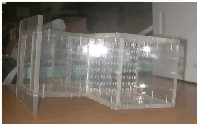
Figura 1.1: Dispositivo generador de turbulencia con matriz de chorros
