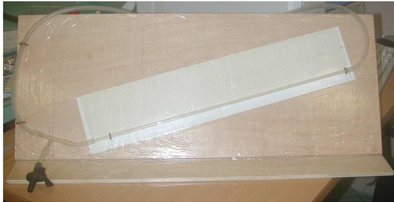
Figura 1.12: Soporte para la columna de líquido del Pitot
