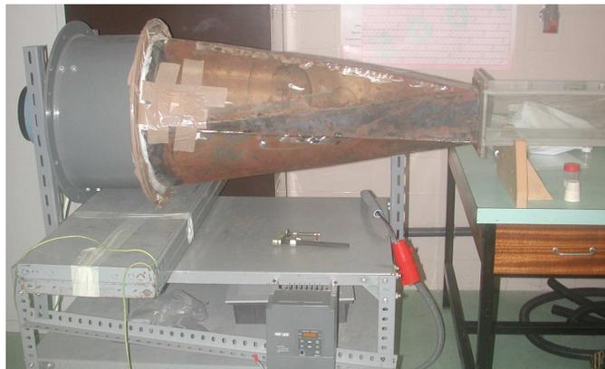
Figura 1.5: Ventilador con tobera metálica, conectado a variador
