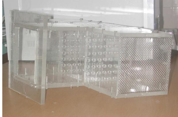
Figura 1.2: Dispositivo generador de turbulencia con malla metálica
