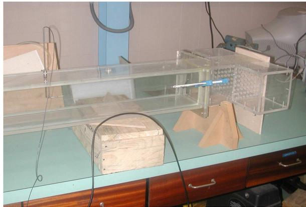
Figura 1.16: Montaje con dispositivo generador de turbulencia
