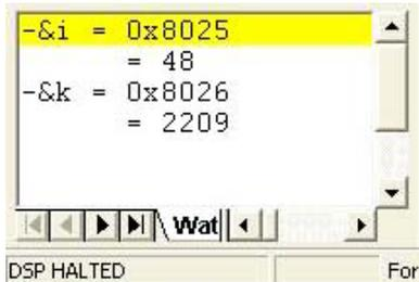
Otro método mucho más rápido para hallar esas direcciones sería utilizando la ventana “Watch Window” en la que se introducen las expresiones “&i” y “&k”. Al desplegarlas pulsando el signo + se mostrarán sus direcciones y valores en ese instante (figura 3.34). Si se ejecuta parcialmente el código se asegura la iniciación de esas variables evitando tomar valores erróneos.
