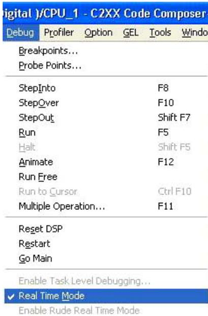
Para que el programa sea monitorizado en tiempo real debe activarse la opción correspondiente mediante Debug->Real Time Mode (figura 3.44). Esto puede provocar que la línea actual a ejecutar (resaltada en amarillo) deje de ser la 0000, con lo que siempre es conveniente hacer otro reset del DSP. De esta forma ya está activo el modo en tiempo real, y así se muestra en la barra de estado en la zona inferior izquierda **REALTIME**. Para ejecutar la aplicación basta con pulsar F5 o mediante “Run”.
