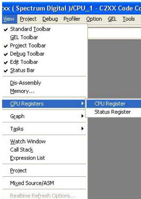
funciones también permiten que el usuario pueda ver la evolución de los registros o la memoria del sistema mediante las ventanas de visualización. Estas ventanas se activan mediante las opciones “Memory”, “CPU Register” y “Status Register” del menú “View” de la barra superior (figura 3.13).
