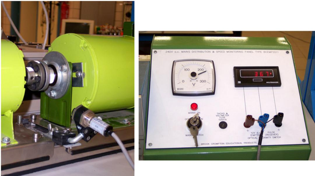
**Figura 5.24. Equipo de medida de velocidad del motor.**
