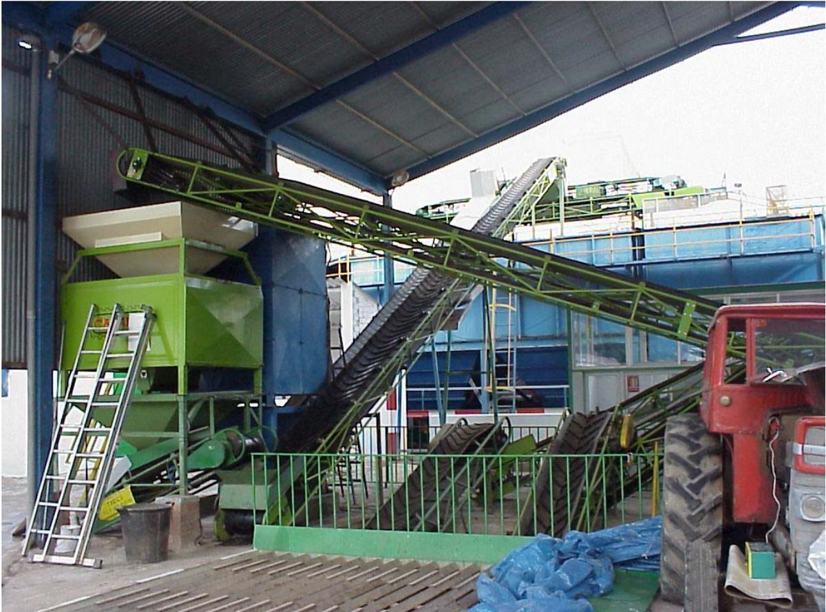
Esta zona sí se encuentra cubierta mediante una estructura metálica con chapas de acero galvanizado. Aquí se encuentran las dos líneas de recepción. En la fotografía se aprecian las tolvas de recepción a ras de suelo y los dos conjuntos de limpiadora y lavadora, que se encontraban cubiertos para evitar la suciedad. Al fondo se distingue la caseta del controlador de pesaje. A la izquierda se puede ver las pesadoras continuas.
