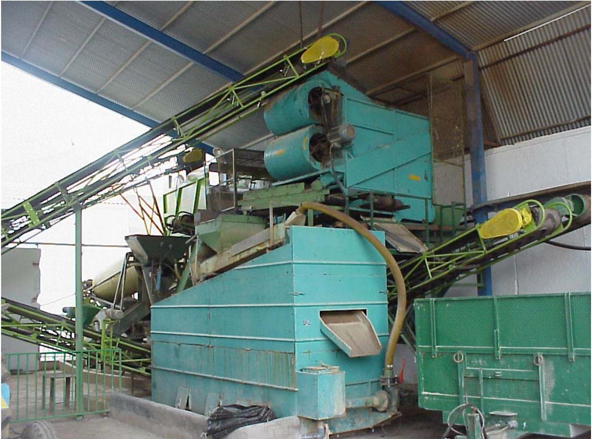
La segunda línea fue montada por Calero y está compuesta por una limpiadora de doble ventilador y criba marca Calero con una capacidad de 30 tm/h y una lavadora de tambor con una capacidad de 25 tm/h. La lavadora se mantiene de la línea que operaba antes de la reforma. Esta línea está en mejor estado, la limpiadora es nueva pero de baja calidad y la lavadora es antigua y de menor capacidad que la limpiadora, por lo que forma un tapón en la línea.
