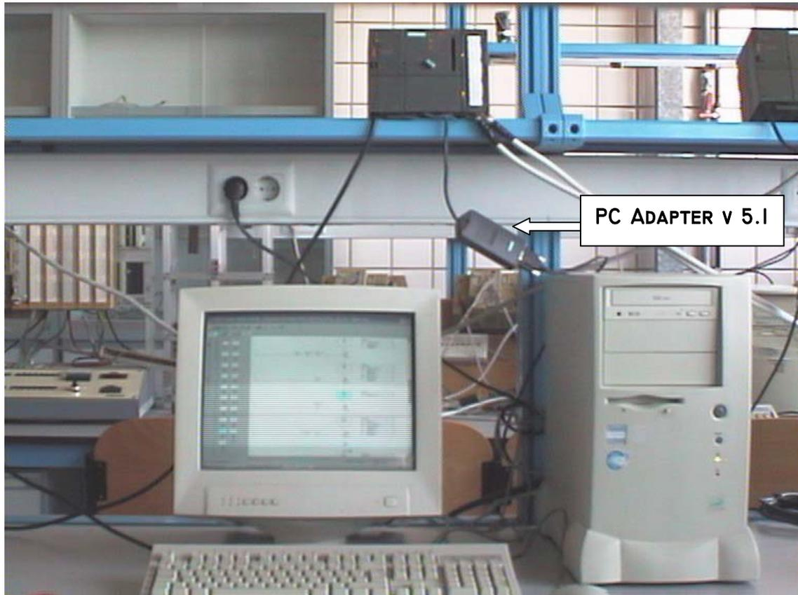
Figura 4.3: Conjunto PLC, PC Adapter y PC.
