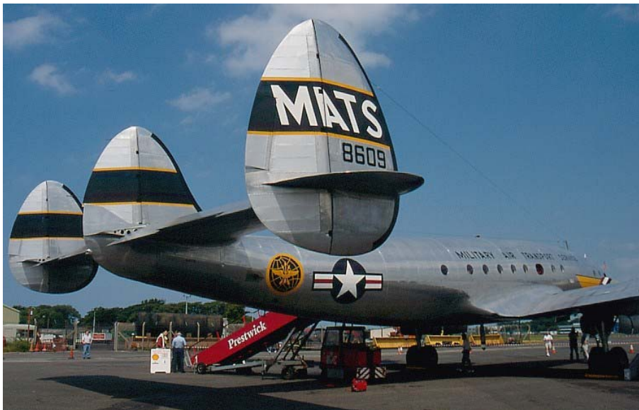
Figura 8.- Empenaje con triple estabilizador vertical.
