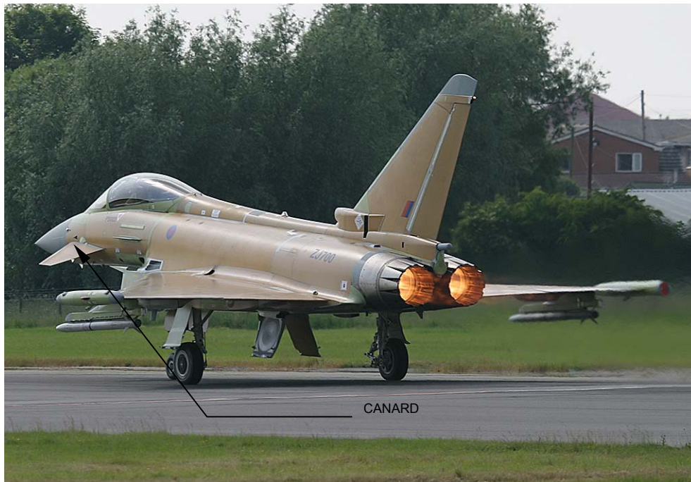
Figura 9.- Estabilizadores tipo "Canard".
