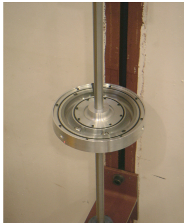
Figura 1.1: Fotografía de un mecanismo ADB con dos bolas utilizado en laboratorio para la realización de ensayos experimentales.
