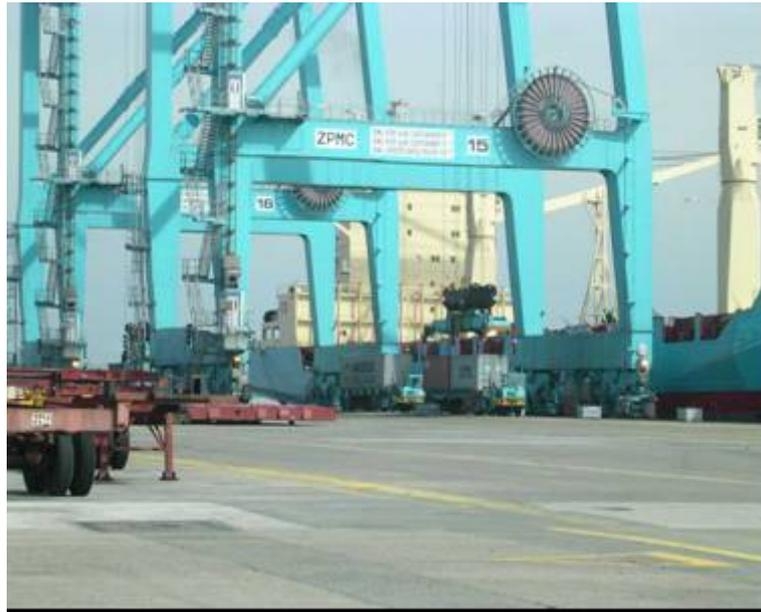
Imagen 3.3 Portainer depositando un contenedor en una cabeza tractora.
