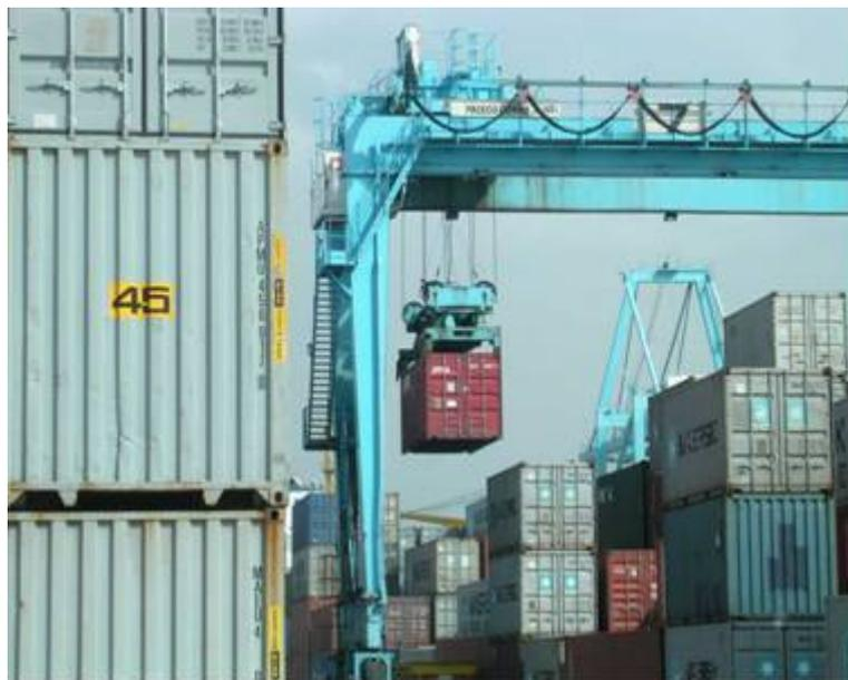
Imagen 3.4. Grúa Trastainer desplazando un contenedor.
