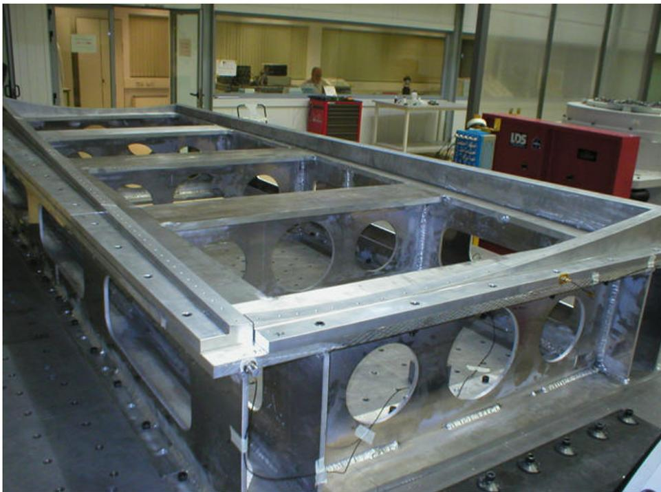
**Fig. 1.2.5.- Disposición del conjunto Útil-Cama durante el ensayo llevado a cabo en el INTA.**
