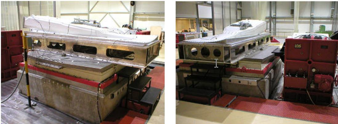
*Fig. 5.3.4.2.- Conjunto fijado para el ensayo de vibración en el eje Y.*
