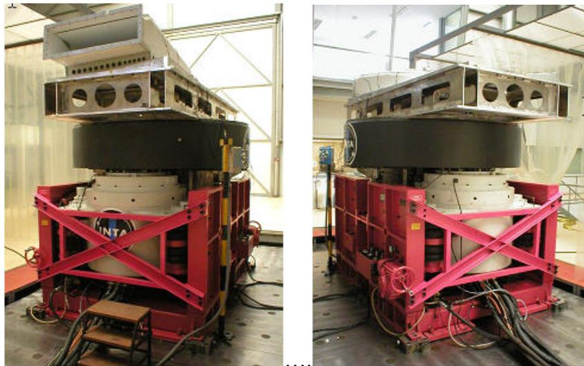
*Fig.5.3.4.3.- Conjunto fijado para el ensayo de vibración en el eje Z.*
