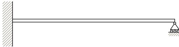
Figura n° 63: Viga empotrada-apoyada.
