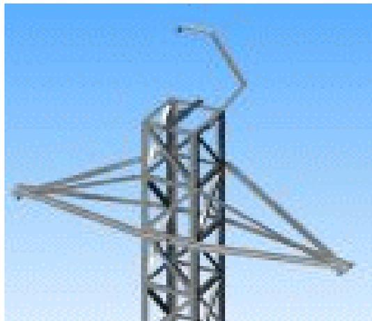
*Figura 1.22 Semicrucetas atirantadas disposición en triángulo.*
