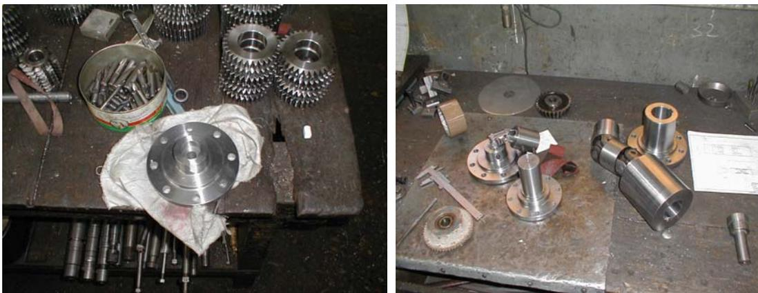
Figura 3.17: a.-)Brida para torsímetro de 500 Nm completa b.-) Conjunto de todas las piezas completas
