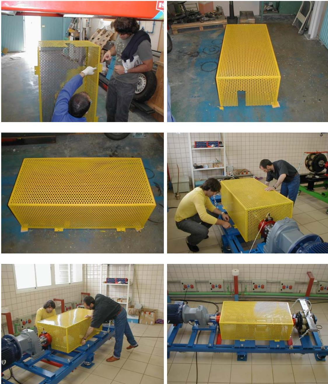
**Figura 3.52: Montaje de la protección**
