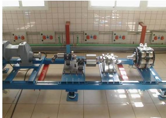
**Figura 3.28: a.-) Casquillo de salida y brida del torsímetro colocadas b.-) Banco completo**
