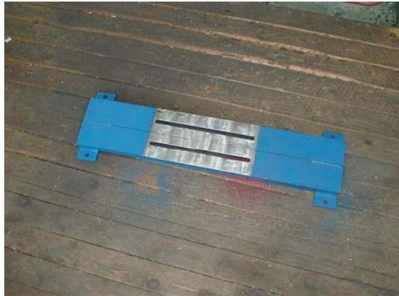
**Figura 3.31: Mecanizado de los travesaños**
