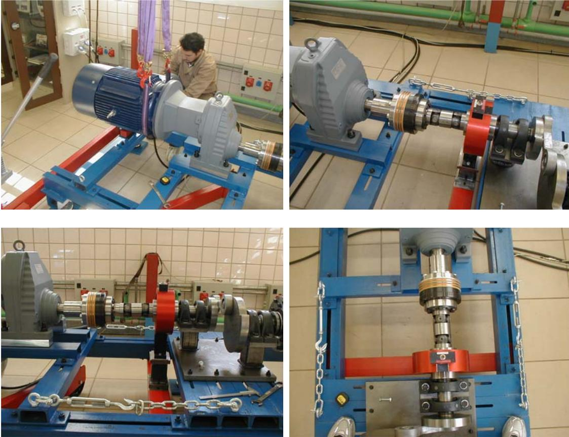
**Figura 3.44: Aproximación de la CVT al torsímetro de entrada**
