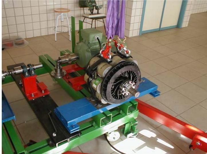
**Figura 3.32: Prueba de vibración**
