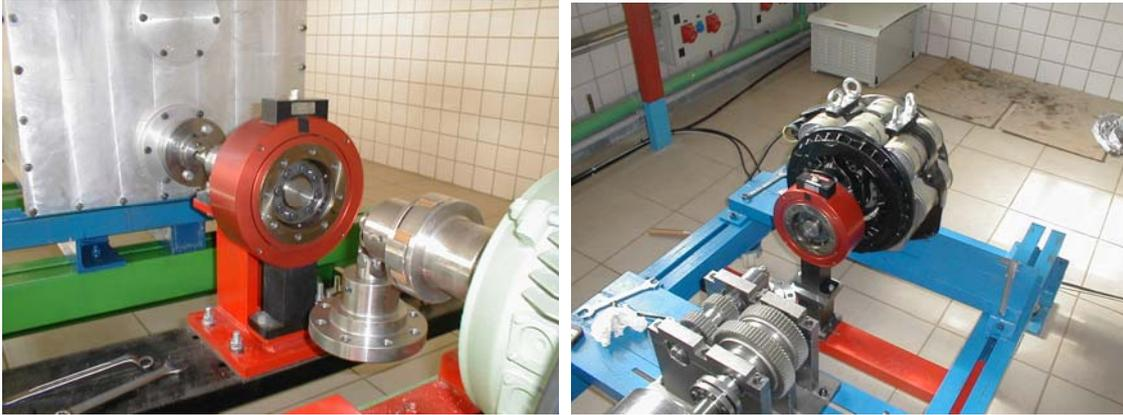
Figura 3.29: Torsímetro de salida
