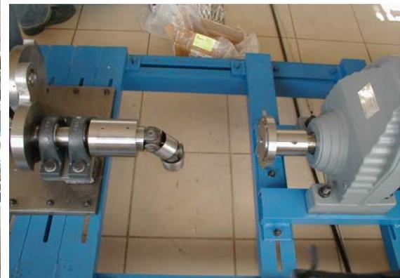
**Figura 3.27: a.-) Casquillo de entrada y brida del motor ya colocados b.-) Apretando el casquillo de entrada a CVT**
