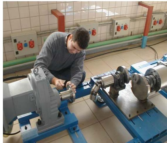
**Figura 3.26: a.-) Colocando los travesaños b.-) Apretando las bridas**
