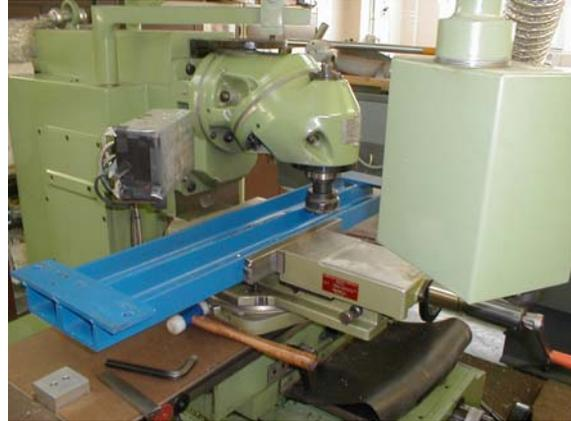
**Figura 3.30: Mecanizado de los travesaños**
