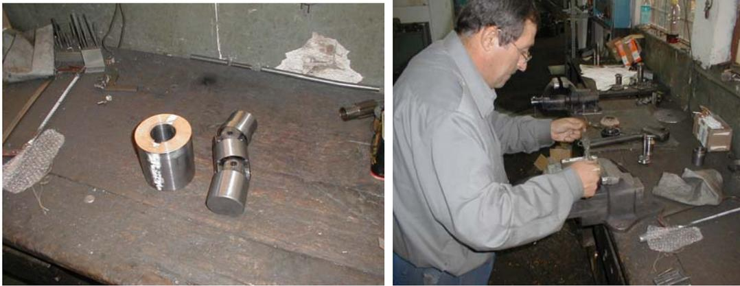
Figura 3.16: a.-) Casquillo de entrada a CVT y cardan FD-72 completos b.-) Roscado de las fijas de los casquillos
