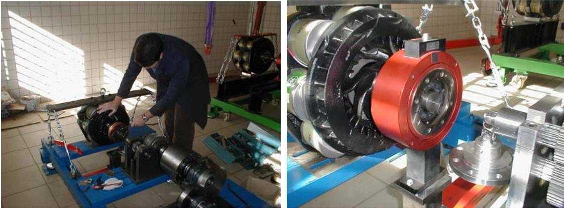
**Figura 3.37: Torsimetro de salida**
