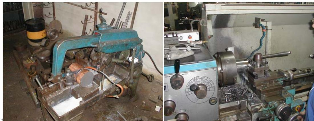
Figura 3.15: a.-) Cortado de material en bruto para las bridas del torsímetro b.-)Casquillo de entrada a CVT en el torno
