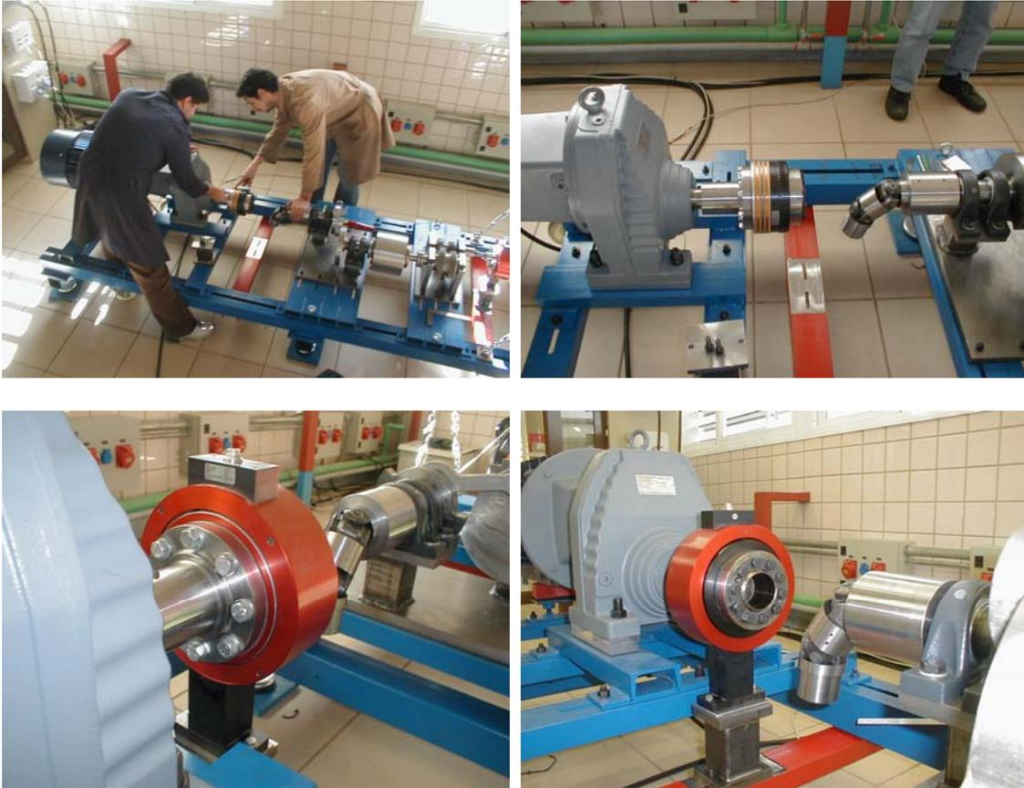
Figura 3.43: Montaje del torsímetro de entrada
