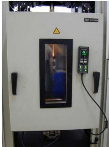
Fig 3.22. Montaje para el ensayo de tracción a temperatura.
