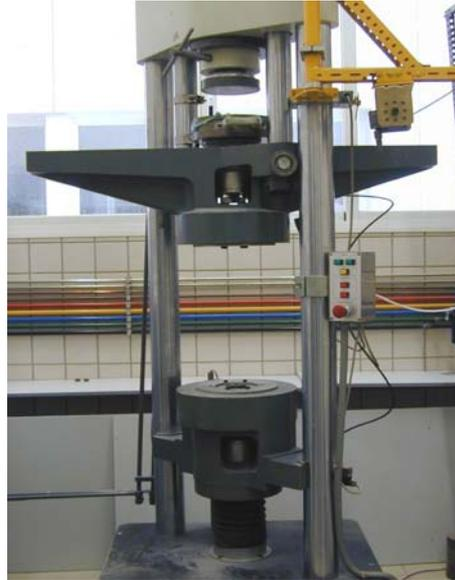
Fig 3.9. Máquina universal de ensayos para el prensado de los polvos.
