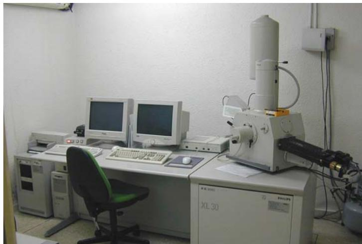
Fig 3.4. Microscopio electrónico de barrido PHILIPS XL-30.
