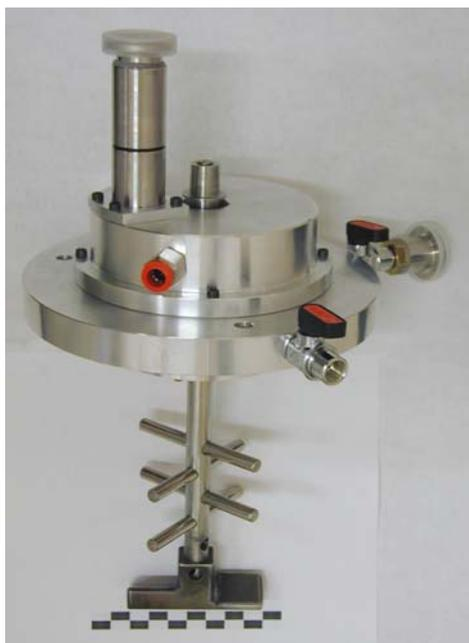
Fig 3.7. Tapadera para la realización de moliendas en diferentes atmósferas.
