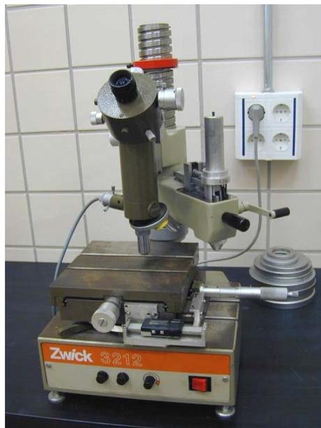
Fig 3.19. Durómetro ZWICK 3212
