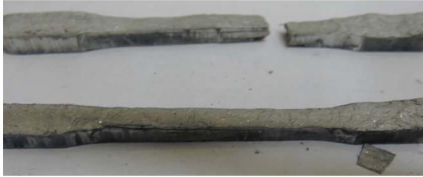
Fig 5.8 . Probetas Al AM 5 prensadas a 850 MPa tras su extracción de la matriz de prensado.
