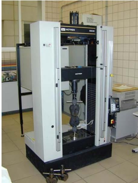
Fig 3.18.. Máquina universal de ensayos INSTRON 5505.
