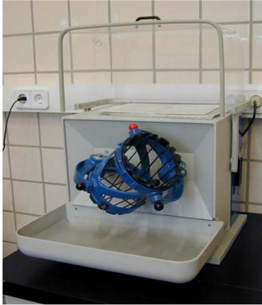
Fig 3.8. Molino Mezclador “Turbula Type T2 C”
