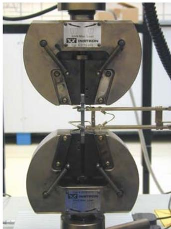
Fig 3.21. Montaje de las probetas y el extensómetro durante el ensayo de tracción.
