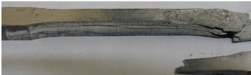
Fig 5.9. Probetas Al AM 5 prensadas a 1125 MPa tras su extracción de la matriz de prensado.
