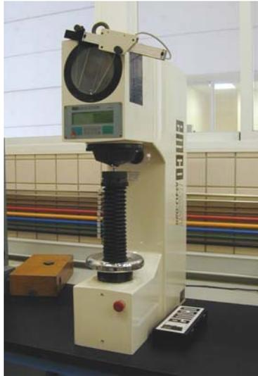
Fig 3.17. Durómetro universal empleado.
