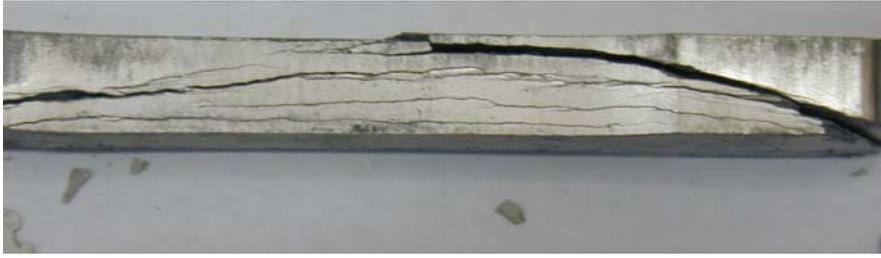
Fig 5.10. Exfoliación de las probetas Al AM 5 + 0,6 Si prensadas a 1125 MPa tras su extracción de la matriz de prensado.
