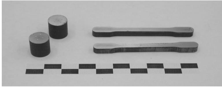
Fig 3.11. Compactos de tipo cilíndrico y de tracción.
