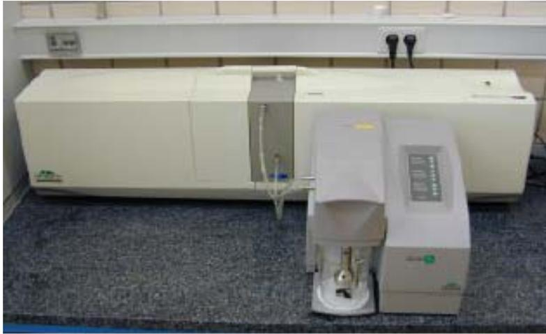
Fig 3.1. Equipo para ensayo de granulometría marca MASTERSIZER.
