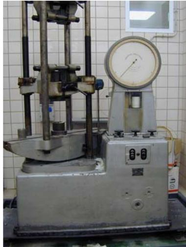
Fig 3.12. Prensa utilizada para el ensayo de compresibilidad.
