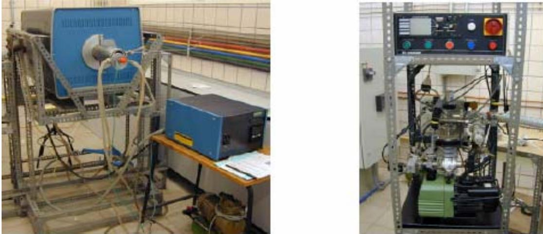
Fig 3.15. (a) Horno de tubo horizontal LINDBERG, y (b) equipo de vacío TELSTAR.
