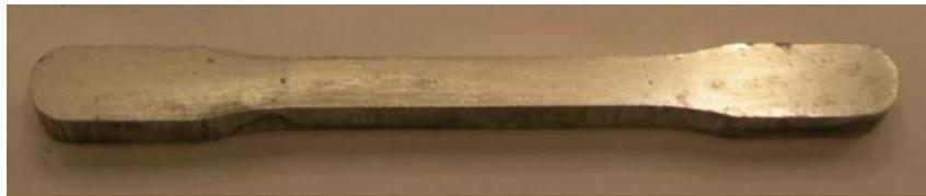
Fig 5.11. Consolidación de las probeta Al AM 5 prensadas a 850 MPa y con 4 % ACP en masa.
