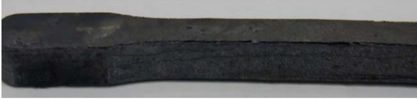
Fig 5.12. Probeta Al AM 5 prensadas a 850 MPa y con 4 % ACP en masa, tras el sinterizado.
