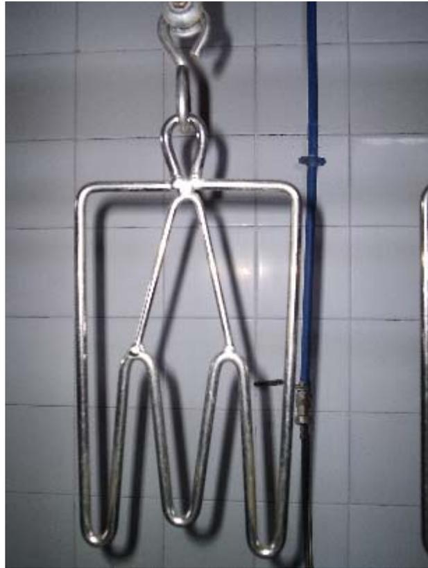
*Fig. 6.3. Percha de la línea aérea de transporte*
