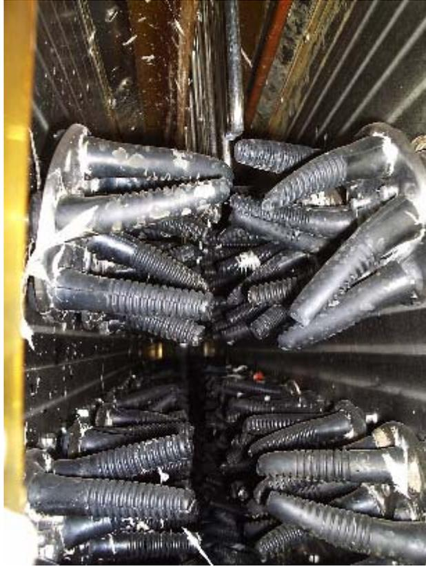
*Fig. 6.10. Detalle de máquina desplumadora*
