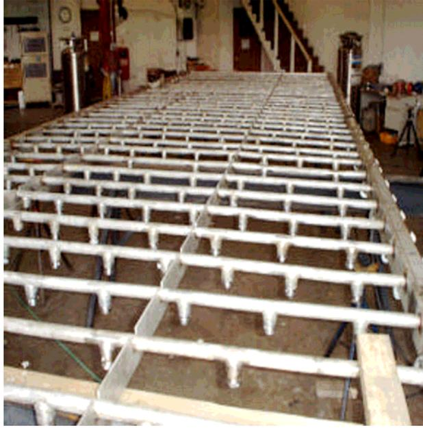
Fig 19. Parrilla de inyectores para un sistema de compresión húmeda.
