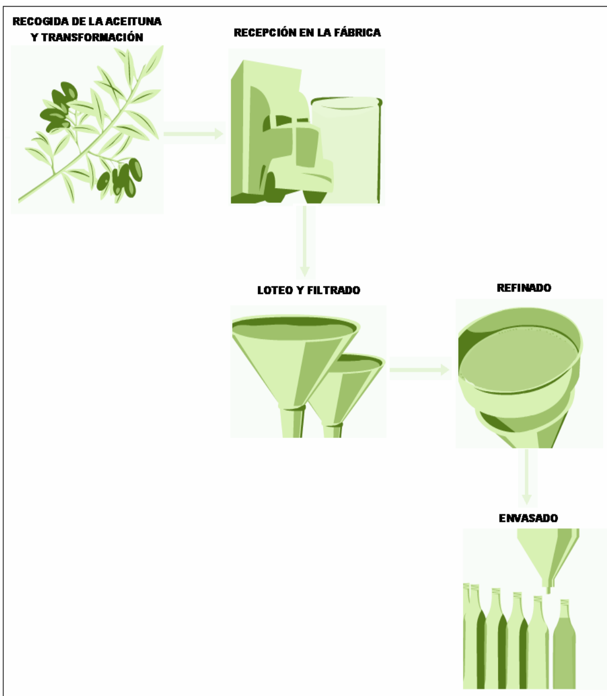
Figura 2.2.2: Esquema del procesado del aceite de oliva
