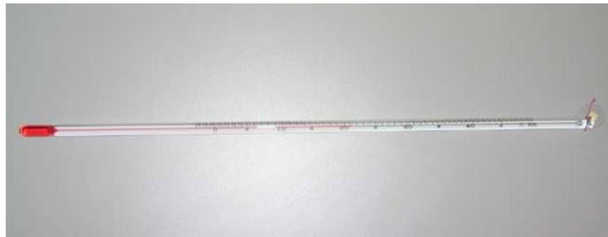
*Figura 4.1. Termómetro de bulbo seco*
