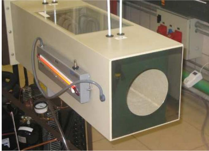
Figura 4.6. Sección con orificio calibrado a la salida de la unidad
