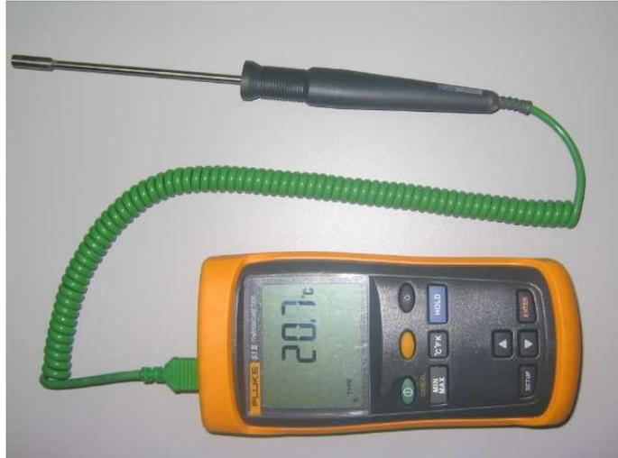
*Figura 4.3. Termopar utilizado en el punto de descarga del compresor*
