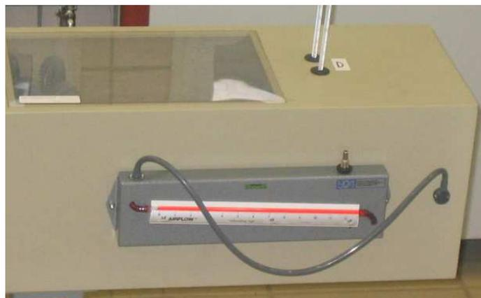
*Figura 4.4. Manómetro inclinado situado a la salida del aire*
