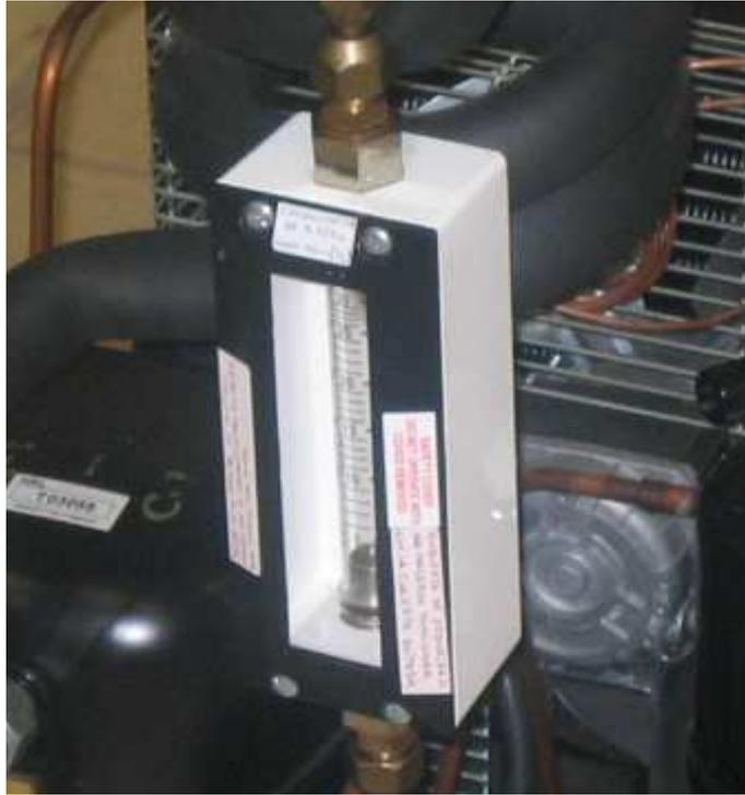
*Figura 4.7. Rotámetro en el ciclo de producción de frío*
