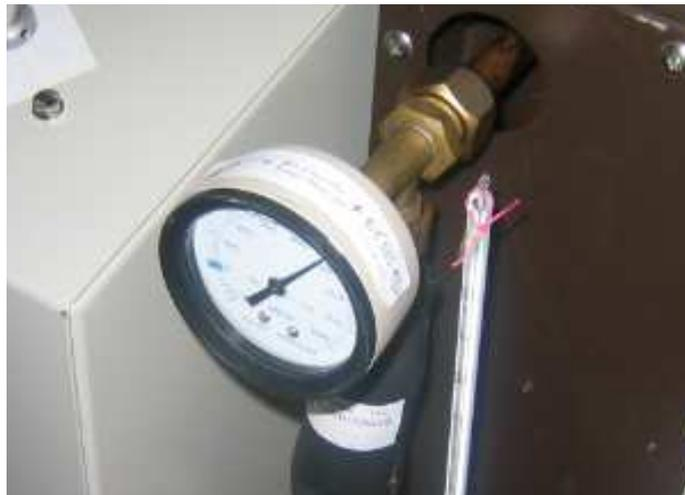
Figura 4.5. Manómetro de tubo Burdon en el ciclo de producción de frío
