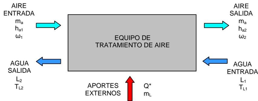
Figura 1.5. Esquema de un proceso genérico de tratamiento de aire
