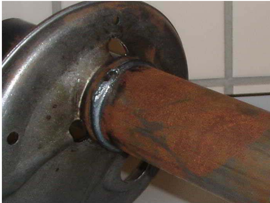
Fig. 1.2-1. Unión soldada de asiento y tubo.
