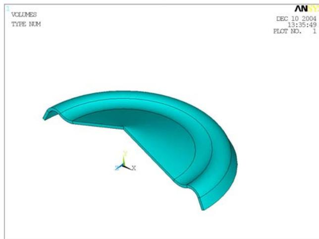
Fig. 4.1.1-3. Volumen generado por rotación que aproxima la geometría del asiento.
