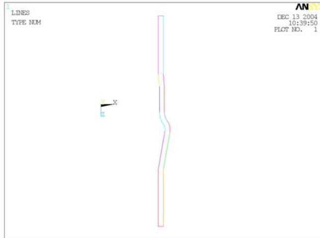
Fig. 4.1.2-1. Líneas que se emplean inicialmente para generar la geometría del tubo.
