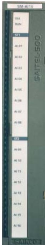
El módulo SM\_AI16 está constituido por dos bloques de entradas analógicas, un bloque controlador y un bloque de indicaciones.
