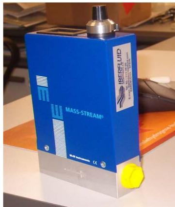
Figura 94.- MFC de 0 a 10 lpm de Iberfluid
