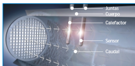
Estructura básica del sensor de caudal MASS-STREAM®
