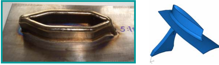
Fig. 1.4.2. Protuberancia creada mediante deposición de metal.
