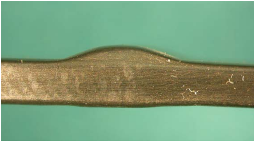
Fig.8.2.2. Fotografía del perfil de una de las probetas PL-101, detalle del cordón de soldadura
