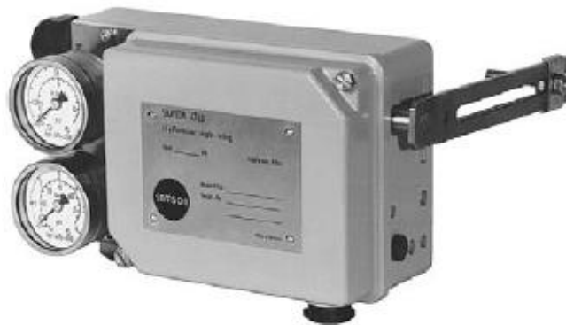
Fig 4: Posicionador SAMSON tipo 4763
