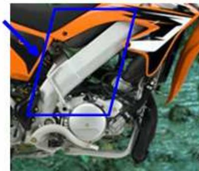
**Figura 6. Chasis delantero del modelo RYZ.**
