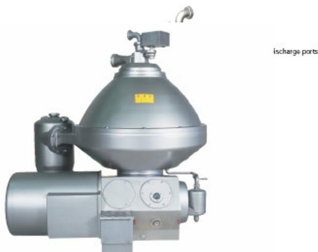
La fase grasa separada apenas sí contiene agua e impurezas sólidas (menos del 0,15% en conjunto), aún así colocaremos un sistema de control de la claridad de dicha grasa, formado por una célula fotoeléctrica que transmite una señal a una válvula que recicla la grasa para sufrir una nueva purificación, esta turbidez de la grasa puede venir dada tanto por impurezas como por gotitas de agua.
