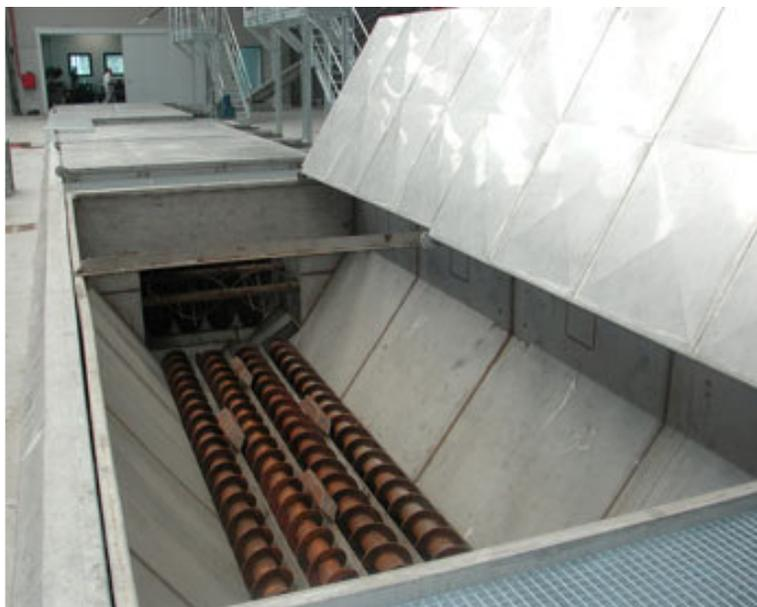
Instalaremos una tolva de recepción ubicada en un foso tal y como se detalla en planos para facilitar la descarga de materia prima de recepción en la misma.
