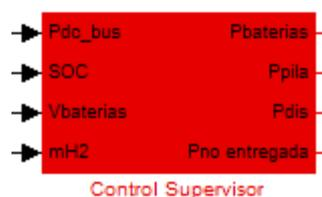
Figura 4.22a: Bloque en simulink del controlador supervisor para ECMS
