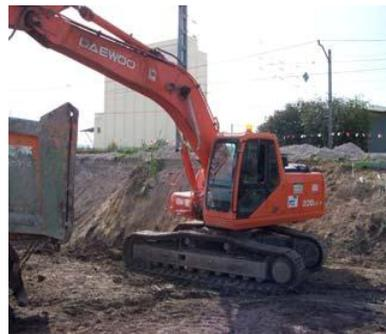
**Figura 3.2. Excavadora de brazo articulado modelo DAEWOO 225LC - V**
