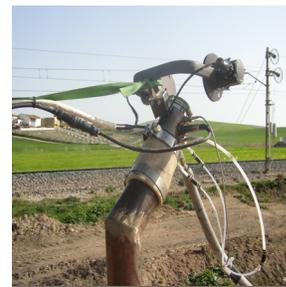
**Figura 3.19b. Ajuste de tubo Pitot en escape mediante goma refractaria**
