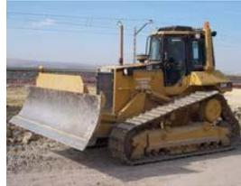
Figura 3.12. Bulldozer CATERPILLAR D6M
