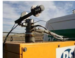
Figura 4.5. Tubo Pitot en tubo de escape
