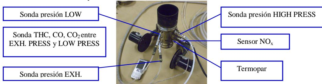
Figura 4.2. Tubo Pitot con conexiones instaladas.
