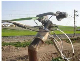
**Figura 4.17. Tubo Pitot colocado en escape**
