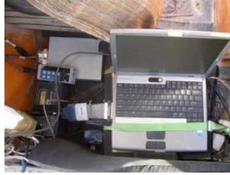
**Figura 4.19. Situación del ordenador portátil, opacímetro y tacómetro**
