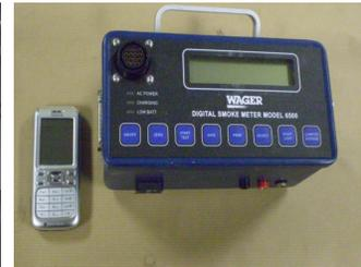
Figura 4.1c Medidor de opacidad
