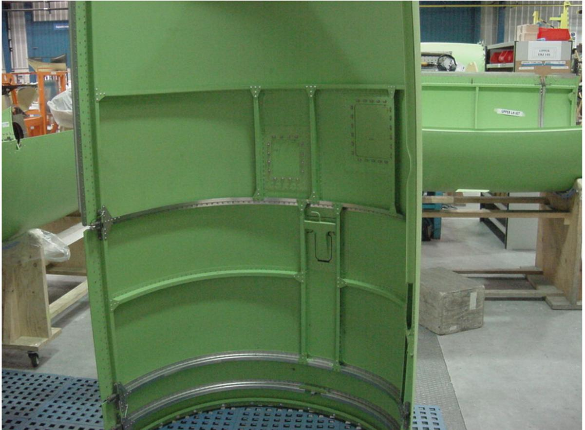
El montaje de los UPPER y LOWER esta dividido entre el que se realiza en el útil (Grada) y el que se realiza sobre unas cunas de madera (Fuera de grada).
